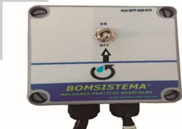
Posicionar a válvula "ITEM 1" na posição de "APLICAÇÃO", com o equipamento parado acionar o painel elétrico chave "A" na posição "ON", efetuar a regulagem de pressão e calibração de vazão de aplicação desejada com a válvula "ITEM 3". (vazão de aplicação deve ser especificada por um agrônomo, exemplo: L/HA, L/MIN).
